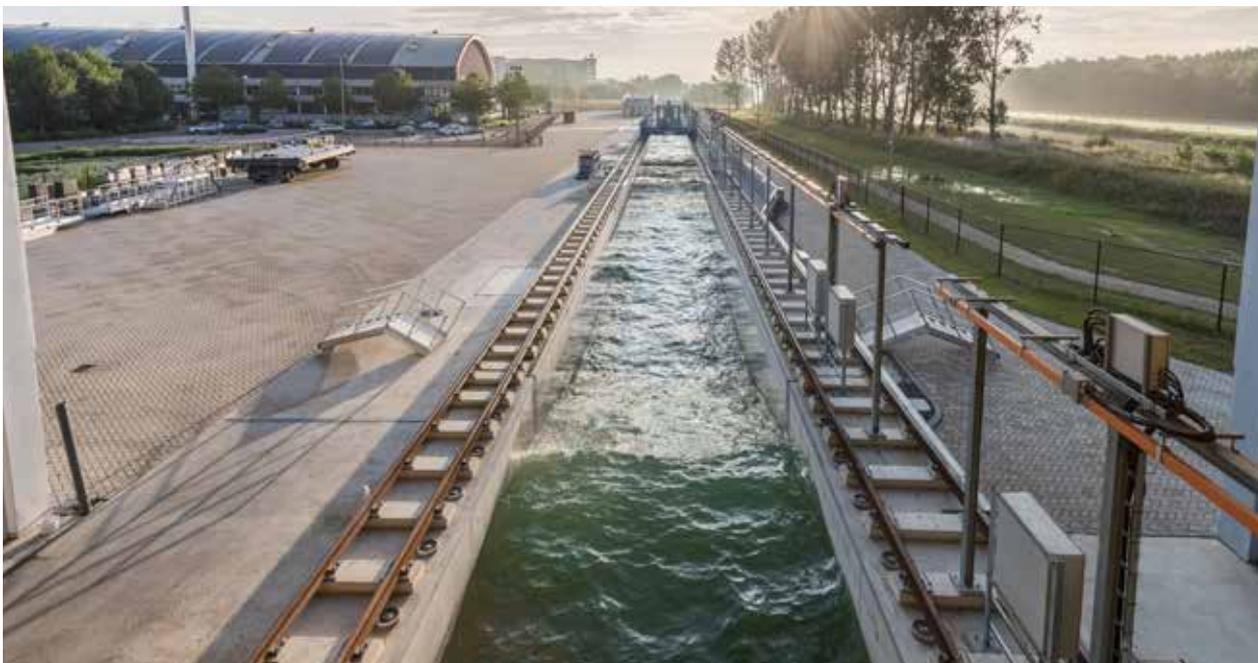
Las instalaciones experimentales, como este canal en el delta del río, pueden utilizarse para probar el desempeño de la vegetación en condiciones extremas.
